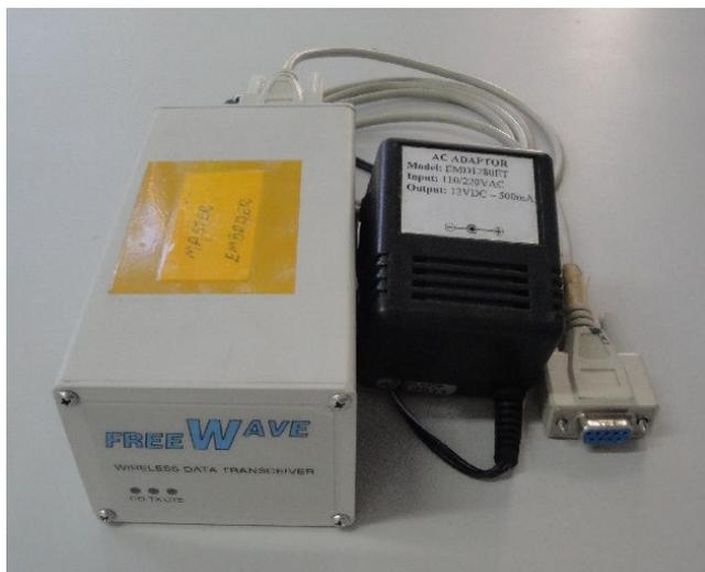
Fig. 10 – Transmissor bidirecional radio-modem.
