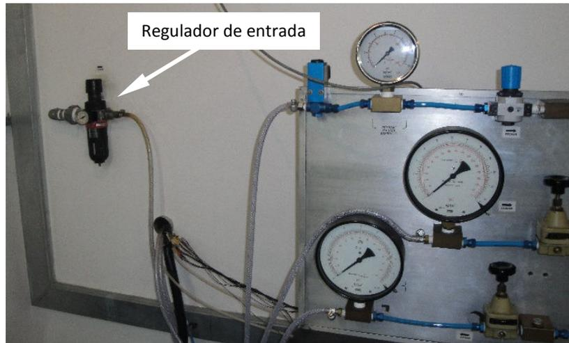
Fig. 7 – Regulador de pressão de entrada com filtro.
