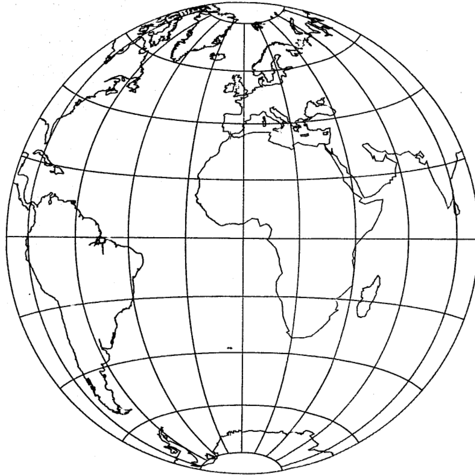
Fig. 9. Projeção Azimutal-Lambert ou plana equivalente.
