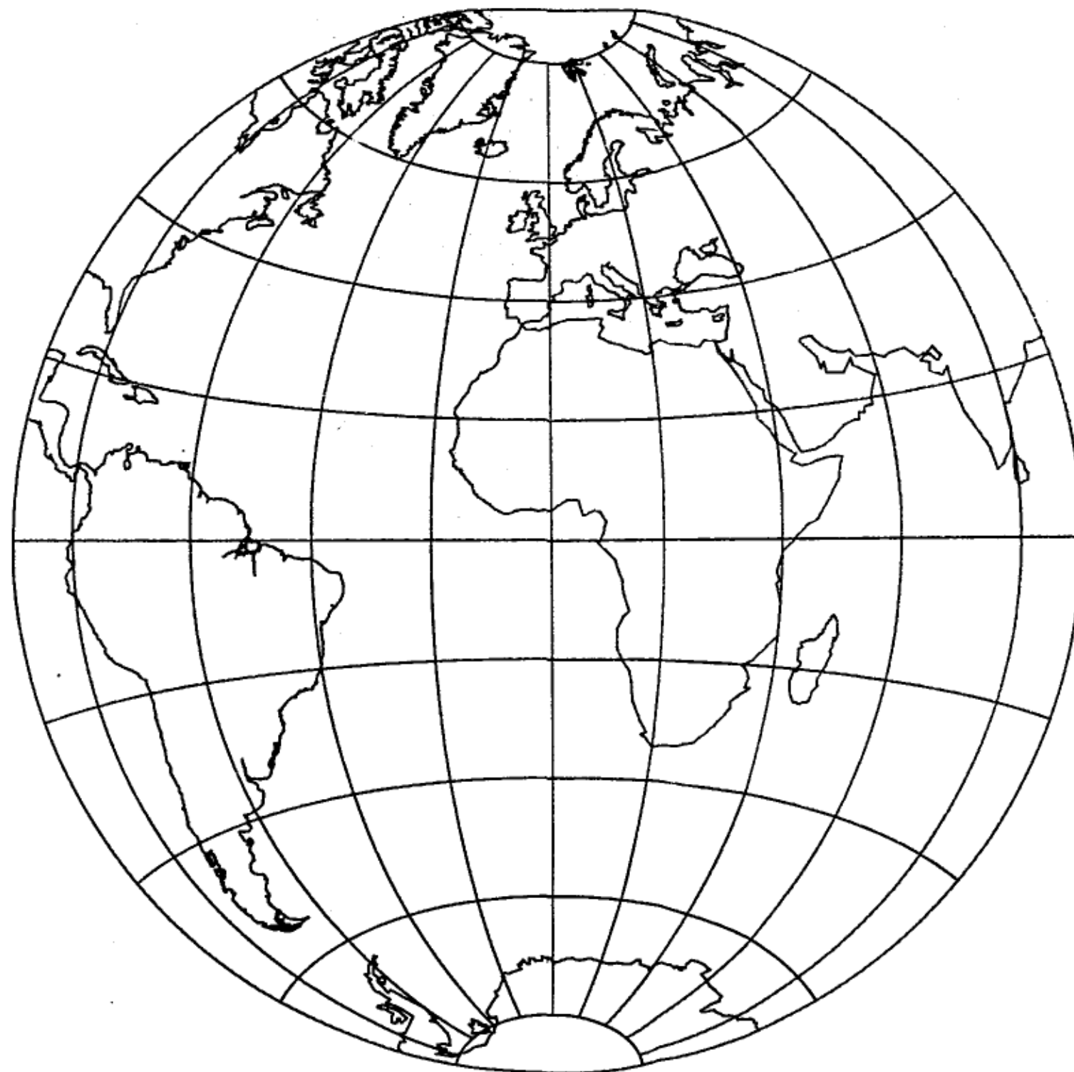
Fig. 8. Projeção Azimutal ou plana eqüidistante azimutal.
