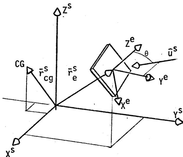
Fig. 2.6 - Sistema do elemento de superfície.
