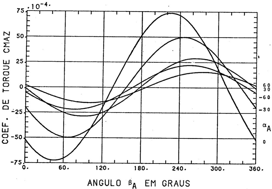
Fig. 7.12 - Coeficiente de torque no eixo  $Z^S$  em função de  $\beta_A$  e  $\alpha_A$  ( $s = 6$ ,  $T_w/T_i = 1$  e  $\sigma = \sigma' = 1$ ).
