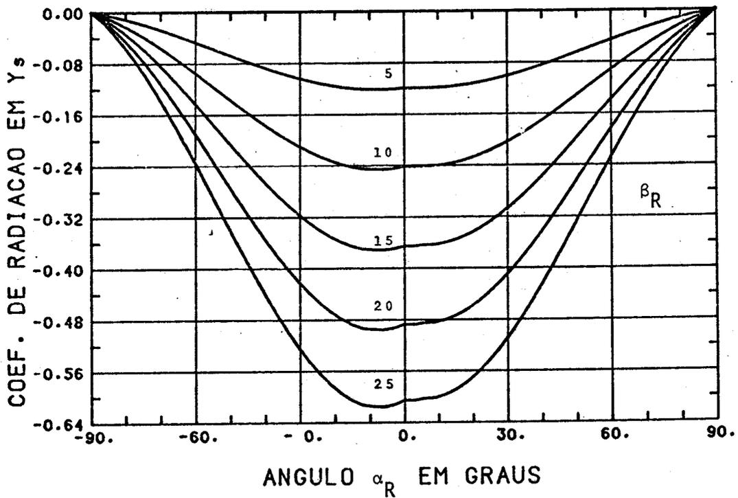
Fig. 7.17 - Componente do coeficiente de força de radiação no eixo Ys, em função dos ângulos alpha\_R e beta\_R, para gamma = rho = 0,7.
