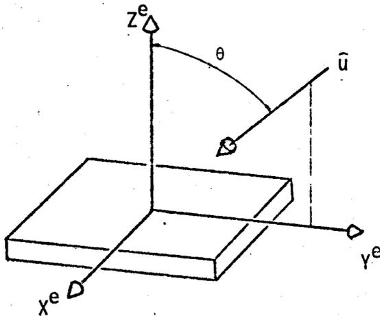
Fig. 3.2 - Sistema de coordenadas no elemento.
