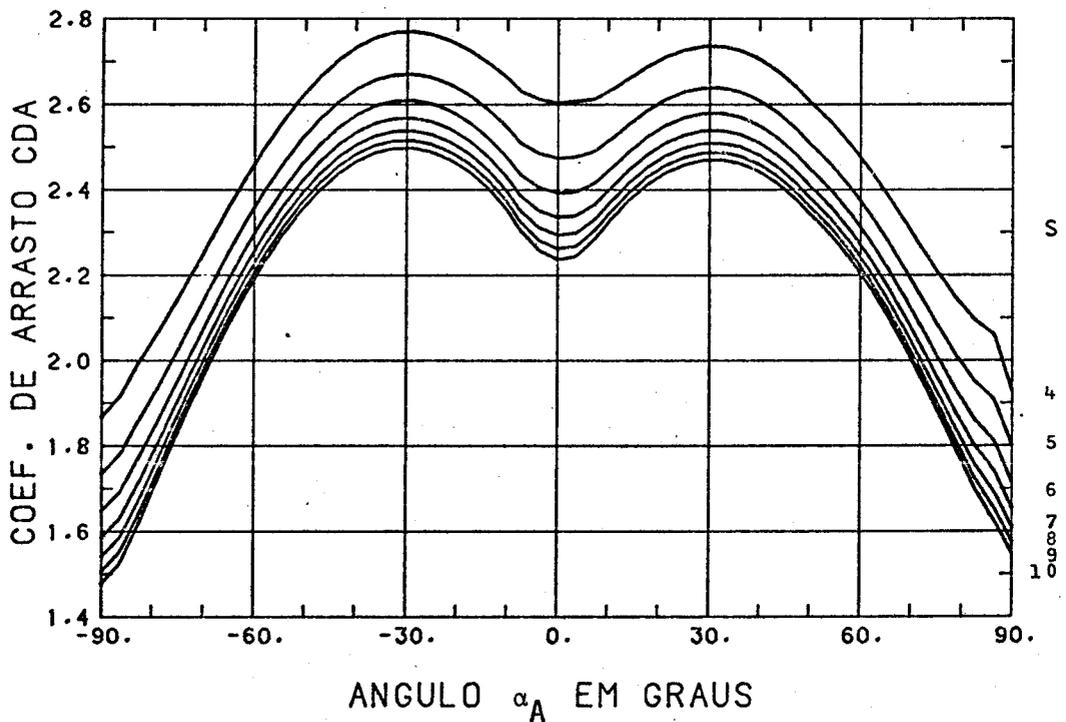
Fig. 7.7 - Coeficiente de arrasto aerodinâmico em função de  $\alpha_A$  e  $s$  ( $\beta_A = 22,5^\circ$  e  $\sigma = \sigma' = T_w/T_i = 1$ ).
