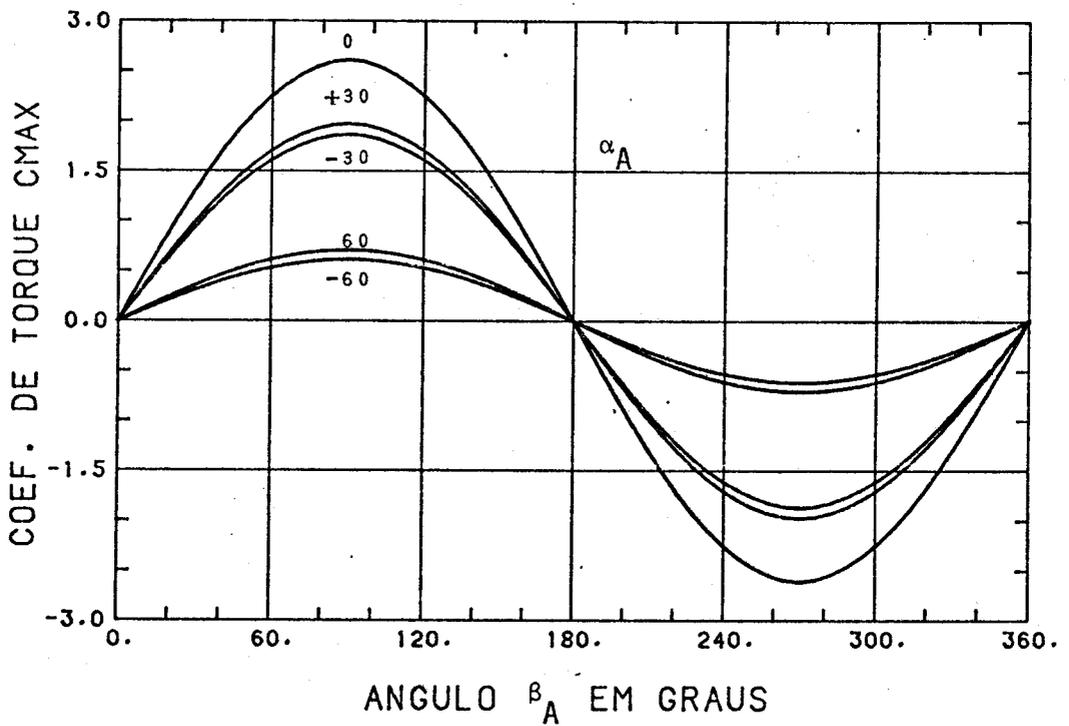
Fig. 7.10 - Coeficiente de torque no eixo  $X^S$  em função de  $\alpha_A$  e de  $\beta_A$  ( $\sigma = \sigma' = T_W/T_i = 1$ ,  $s = 6$ ).
