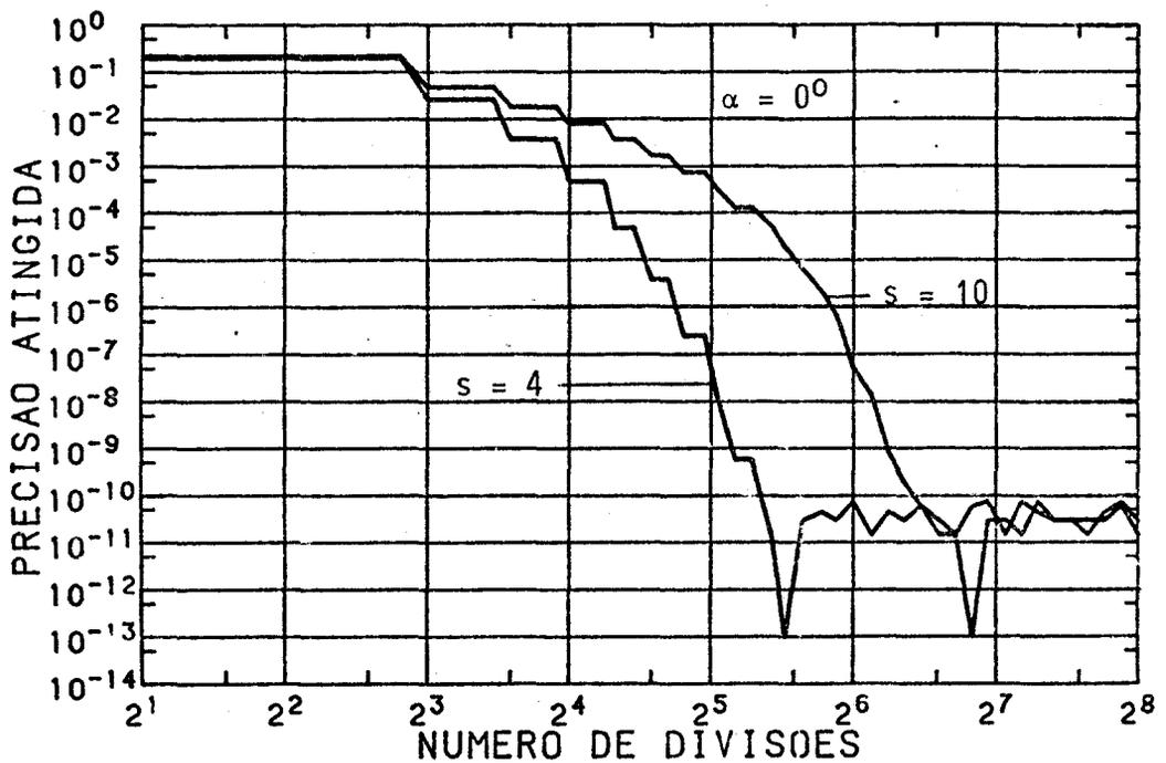
Fig. A.2 - Precisão do integrador numérico em função do número de divisões num cilindro.
