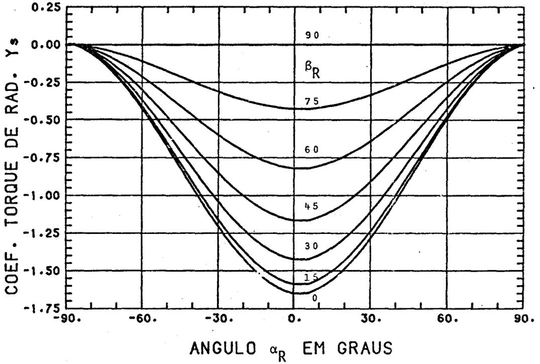
Fig. 7.25 - Componente do coeficiente de torque de radiação no eixo  $Y^s$  em função de  $\alpha_R$  e  $\beta_R$  ( $\gamma = \rho = 0,7$ ).
