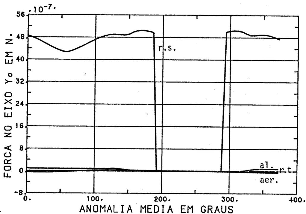
Fig. 7.52 - Forças em N no eixo Y<sup>0</sup> (elementos orbitais: a = 7128 km, e = 0,007, i = 22<sup>o</sup>, Ω = 180<sup>o</sup> e ω = 14,3<sup>o</sup>).
