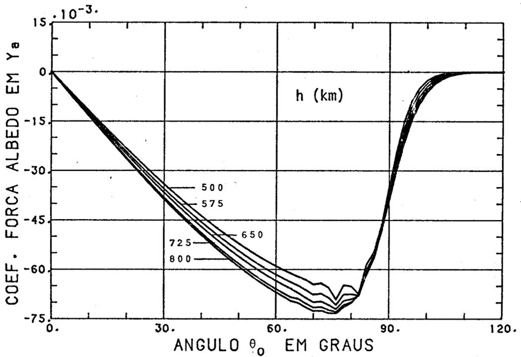
Fig. 7.31 - Coeficiente do albedo na direção horizontal,  $Y^S$ , em função de  $\theta_0$  e de  $h$  ( $\phi_s = \theta_s = \psi_s = 0$  e  $\gamma = \rho = 0,7$ ).
