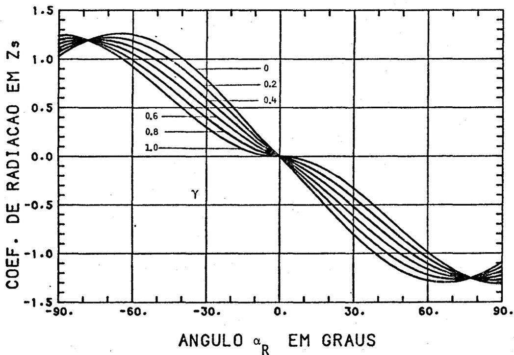
Fig. 7.23 - Componente no eixo  $Z^S$  do coeficiente de radiação em função de  $\alpha_R$  e  $\gamma$  ( $\beta_R = 22,50$  e  $\rho = 1,0$ ).
