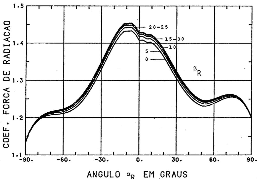
Fig. 7.14 - Coeficiente de força de radiação em função dos ângulos  $\alpha_R$  e  $\beta_R$  (coeficiente de reflexão:  $\gamma = \rho = 0,7$ ).
