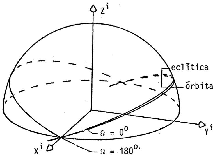
Fig. 7.44 - Configuração entre o plano orbital e a eclíptica para  $\Omega = 0^\circ$  e  $\Omega = 180^\circ$ .
