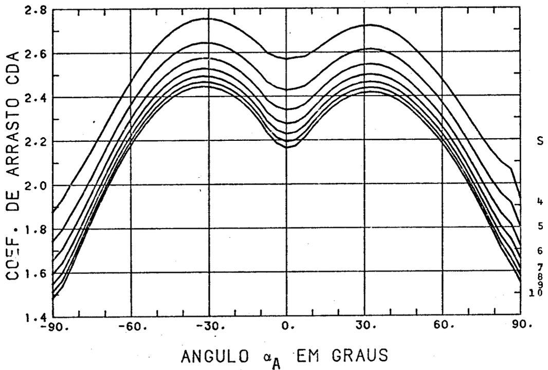
Fig. 7.6 - Coeficiente  $C_{DA}$  em função do ângulo  $\alpha_A$  e da razão de velocidades  $s$  ( $\beta_A = 0$ ,  $\sigma = \sigma' = T_w/T_i = 1$ ).
