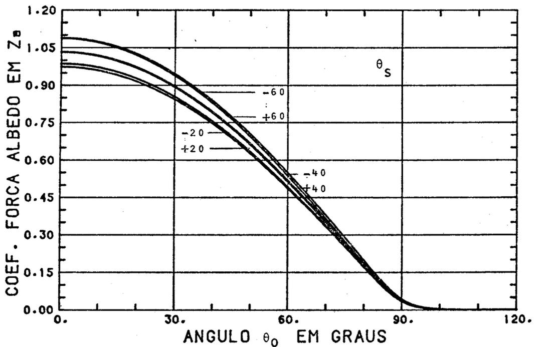
Fig. 7.32 - Componente vertical do coeficiente do albedo em função de  $\theta_0$  e  $\theta_s$  ( $\gamma = \rho = 0,7$ ,  $\phi_s = \psi_s = 0$  e  $h = 700$  km).
