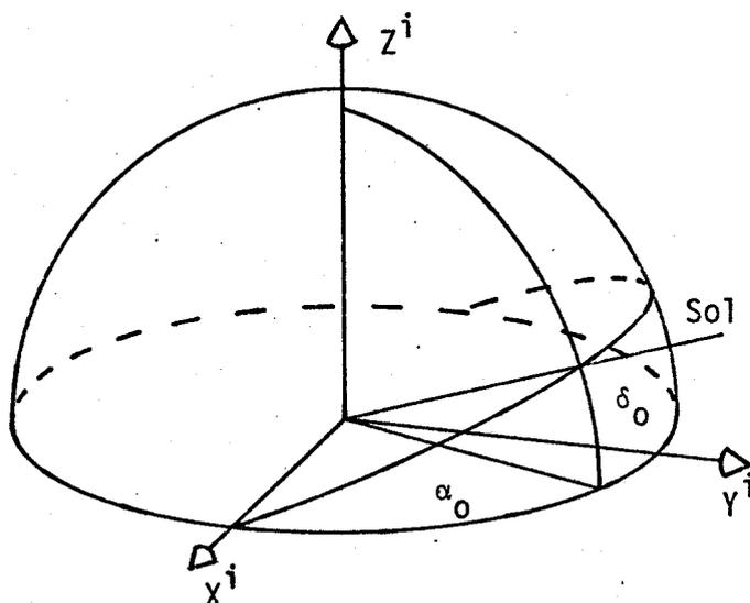
Fig. 2.2 - Sistema de referência geocêntrico inercial.
