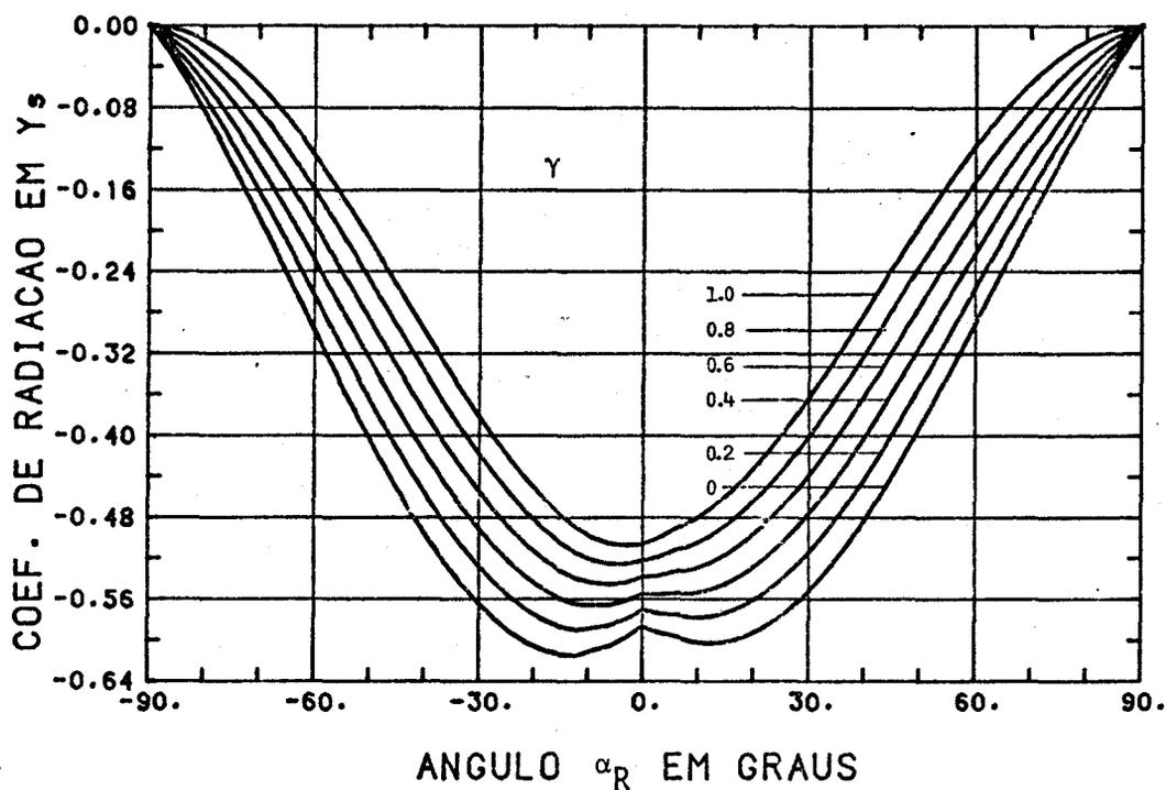
Fig. 7.22 - Coeficiente de radiação projetado no eixo  $Y^S$ , em função de  $\alpha_R$ , para alguns valores de  $\gamma$  ( $\beta_R = 22,50$  e  $\rho = 1,0$ ).
