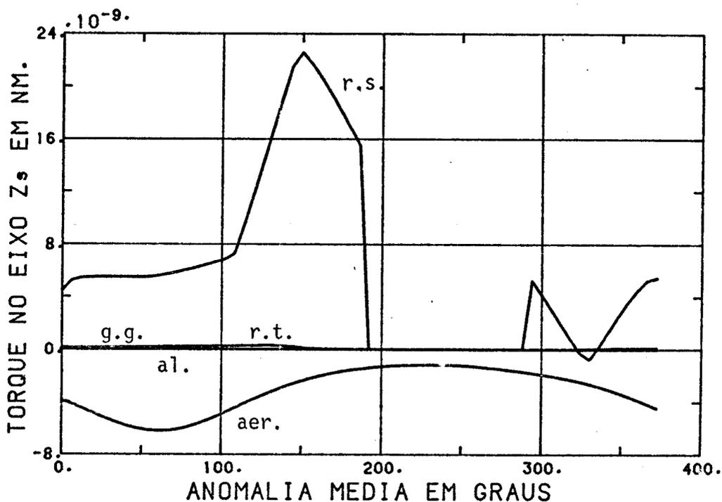
Fig. 7.56 - Torques no eixo  $Z^S$  em Nm (ângulos de atitude com relação ao sistema  $X^0Y^0Z^0$   $\phi_S = \theta_S = \psi_S = 0$ ).
