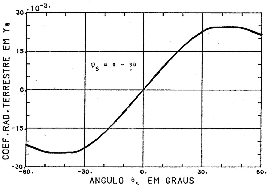
Fig. 7.38 - Coeficiente horizontal da radiação terrestre em função de  $\theta_s$  e  $\psi_s$  ( $h = 700$  km;  $\phi_s = 0$  e  $\gamma = \rho = 0,7$ ).
