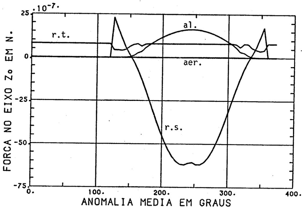
Fig. 7.47 - Forças no eixo Z<sup>0</sup> (elementos orbitais: a = 7128 km, e = 0,007, i = 22°, Ω = 0° e ω = 14,3°).
