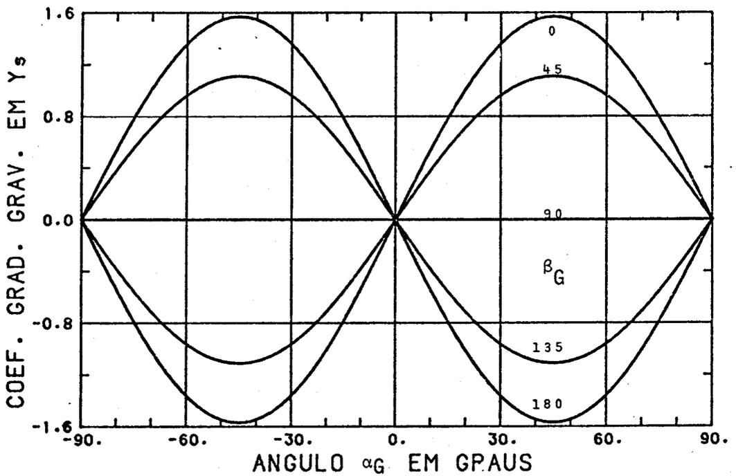
Fig. 7.41 - Coeficiente de torque de gradiente de gravidade no eixo  $Y^S$  em função dos ângulo  $\alpha_G$  e  $\beta_G$ .
