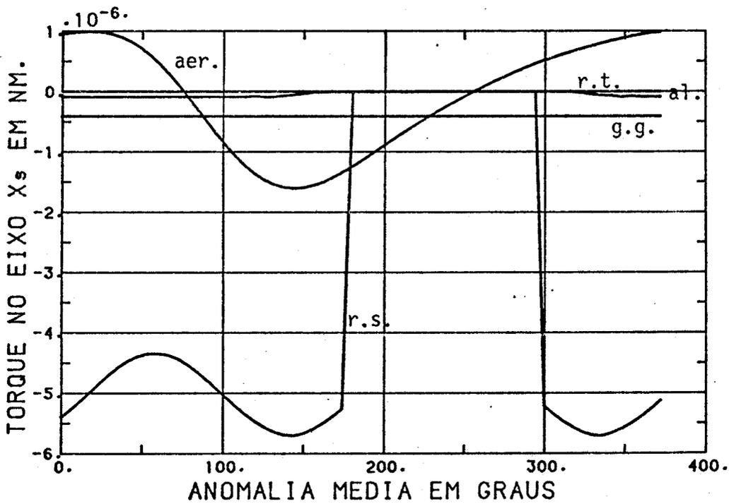
Fig. 7.59 - Torques em Nm no eixo X<sup>S</sup> do sistema do satélite (ângulos de atitude com relação a X<sup>0</sup>Y<sup>0</sup>Z<sup>0</sup>: φ<sub>S</sub> = θ<sub>S</sub> = ψ<sub>S</sub> = 0).
