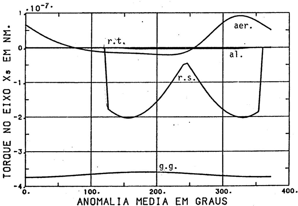
Fig. 7.48 - Torques em Nm no eixo X<sup>s</sup> do sistema do satélite (orientação com relação ao sistema orbital: φ<sub>s</sub> = θ<sub>s</sub> = ψ<sub>s</sub> = 0).
