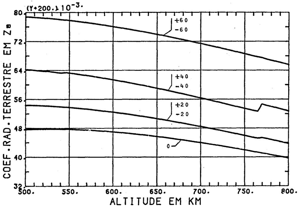
Fig. 7.36 - Coeficiente vertical da radiação terrestre em função de  $h$  e do ângulo  $\theta_s$  ( $\gamma = \rho = 0,7$ ;  $\phi_s = \psi_s = 0^\circ$ ).
