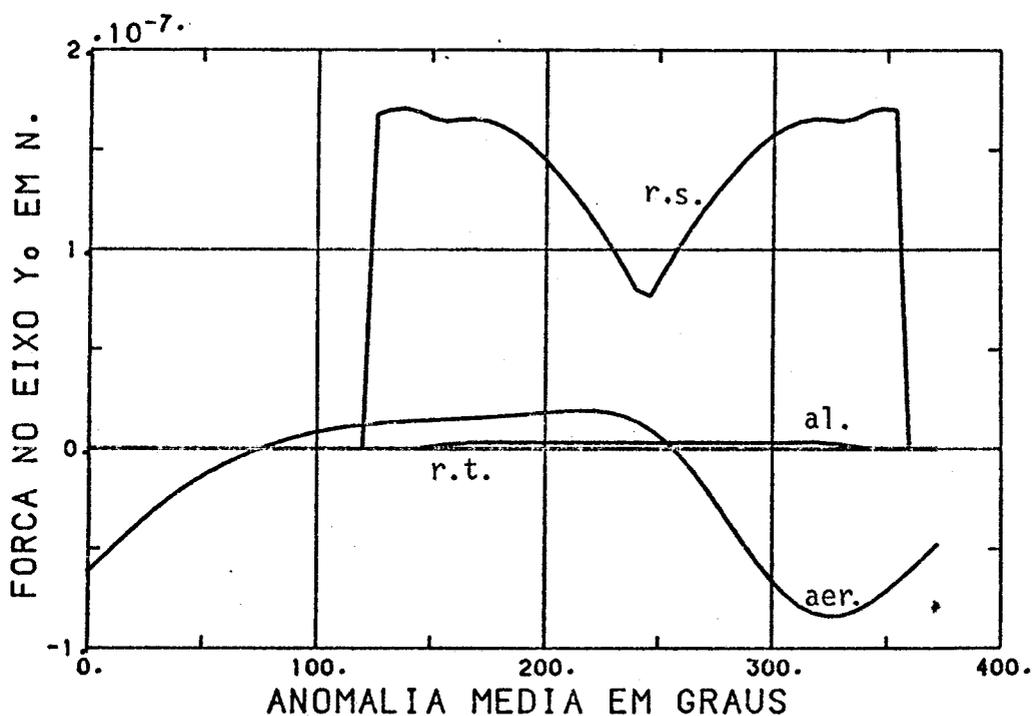
Fig. 7.46 - Forças em N no eixo Y<sup>0</sup>, perpendicular ao plano orbital
