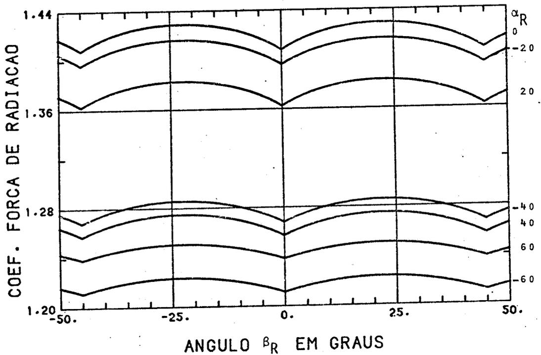
Fig. 7.15 - Coeficiente de força de radiação em função de  $\beta_R$ , para alguns valores de  $\alpha_R$  ( $\gamma = \rho = 0,7$ ).
