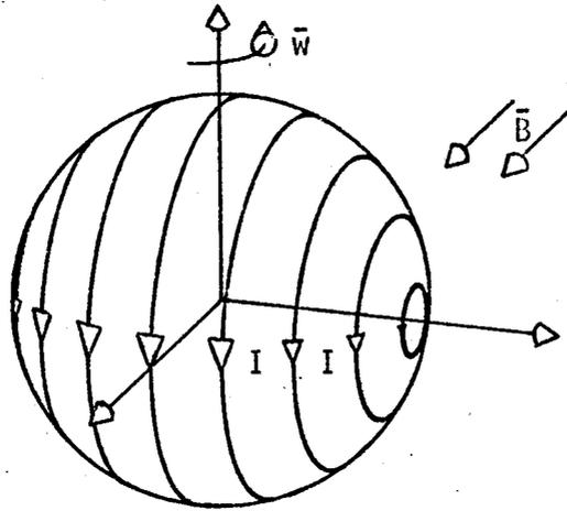
Fig. 6.3 - Correntes elétricas induzidas na superfície do satélite pelo campo magnético da Terra.
