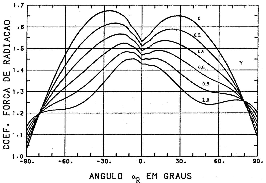
Fig. 7.19 - Influência da reflectância  $\gamma$  no coeficiente de radiação em função de  $\alpha_R$  ( $\beta_R = 22,5^\circ$  e  $\rho = 0,5$ ).
