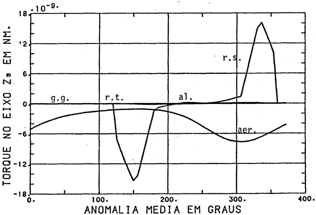
Fig. 7.50 - Torques em Nm no eixo  $Z^S$  (orientação do satélite com relação ao sistema orbital dada por:  $\phi_s = \theta_s = \psi_s = 0$ ).
