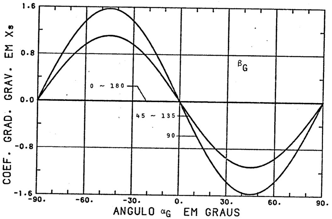
Fig. 7.40 - Coeficiente do torque de gradiente de gravidade no eixo  $X^S$  em função da direção do zênite local,  $\alpha_G$  e  $\beta_G$ .
