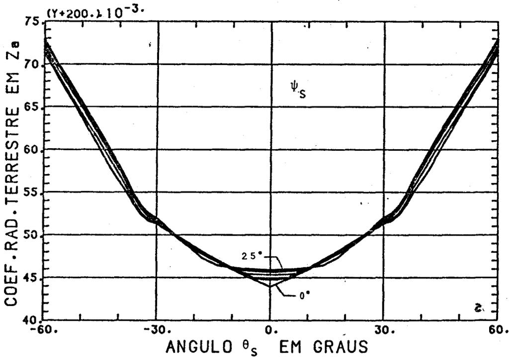
Fig. 7.37 - Componente vertical do coeficiente de radiação terrestre em função de  $\theta_s$  e  $\psi_s$  ( $h = 700$  km;  $\phi_s = 0$  e  $\gamma = \rho = 0,7$ ).
