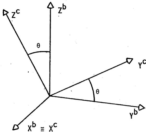
Fig. 2.1 - Rotação sobre o eixo  $X^b$ .
