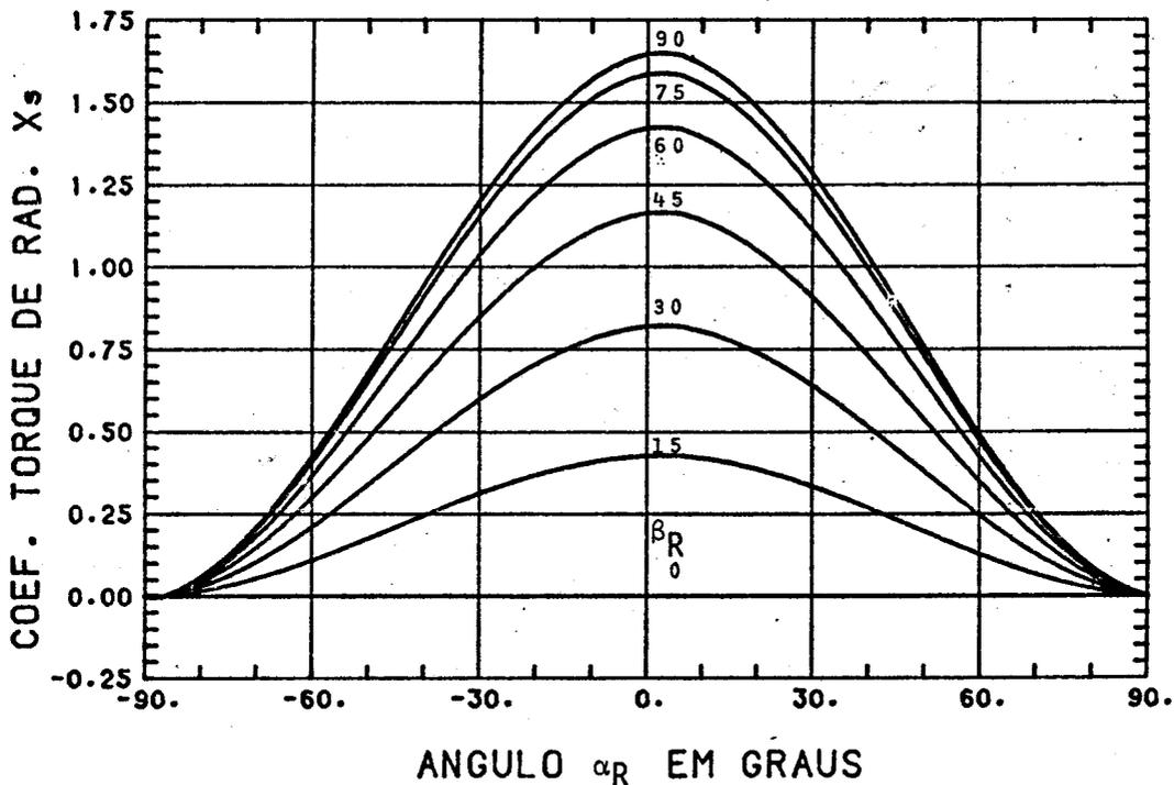
Fig. 7.24 - Coeficiente de torque de radiação no eixo  $X^S$ , em função de  $\alpha_R$  e  $\beta_R$  ( $\gamma = 0,7$  e  $\rho = 0,7$ ).
