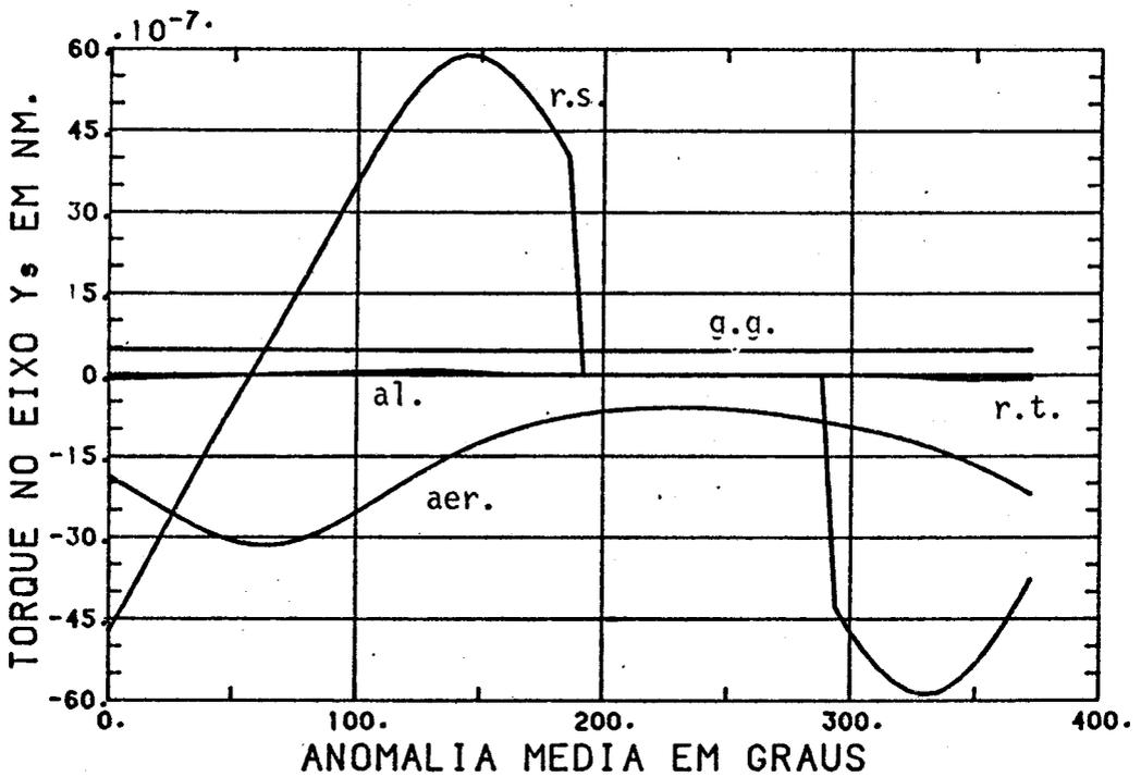
Fig. 7.55 - Torques em Nm no eixo  $Y^S$  do satélite (ângulos de atitude de com relação ao sistema orbital:  $\phi_s = \theta_s = \psi_s = 0$ ).
