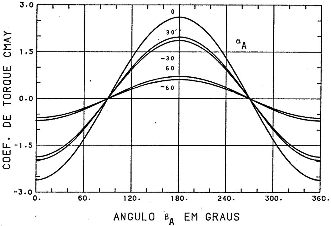
Fig. 7.11 - Coeficiente de torque aerodinâmico  $C_{MAY}$  no eixo  $Y^S$  em função de  $\beta_A$  e  $\alpha_A$  ( $s = 6$ ,  $\sigma = \sigma' = T_w/T_i = 1$ ).
