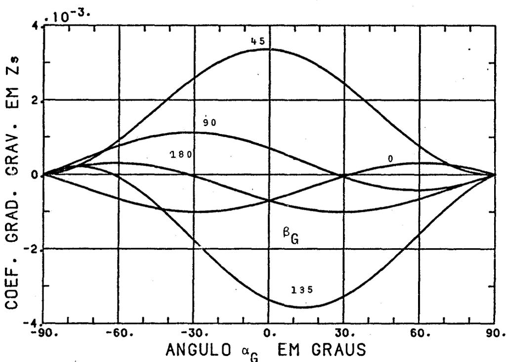
Fig. 7.42 - Coeficiente de torque no eixo  $Z^s$ , devido ao gradiente de gravidade, em função de  $\alpha_G$  e  $\beta_G$ .
