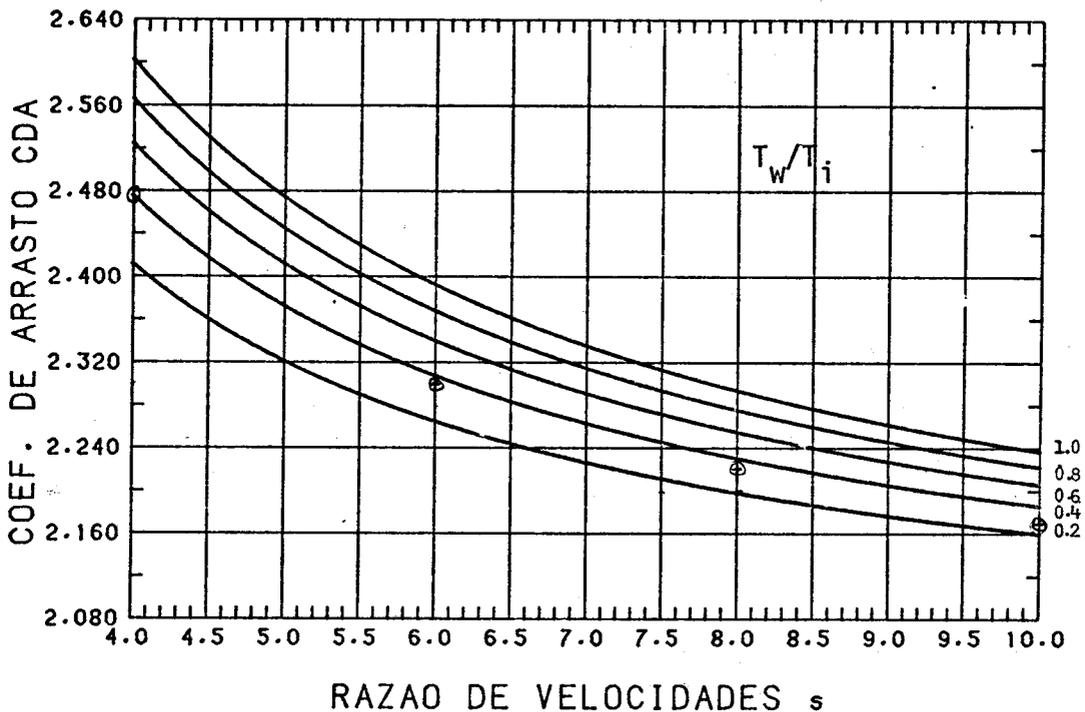
Fig. 7.8 - Variação de  $C_{DA}$  com  $s$  e  $T_w/T_i$  ( $\alpha_A = 0$ ,  $\beta_A = 22,5^\circ$  e  $\sigma = \sigma' = 1$ ).
