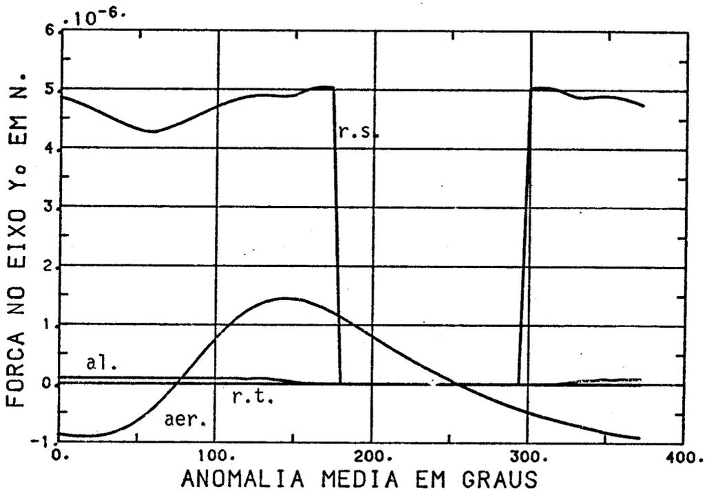
Fig. 7.58 - Forças em N no eixo Y<sup>0</sup> (elementos orbitais: a = 6878 km (500 km de altitude), e = 0, i = 22°, Ω = 180°, ω = 14,3°).
