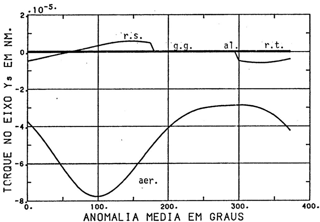
Fig. 7.60 - Torques em Nm no eixo  $Y^S$  (ângulos de atitude com relação ao sistema  $X^0Y^0Z^0$   $\phi_s = \theta_s = \psi_s = 0$  e  $h = 500$  km).
