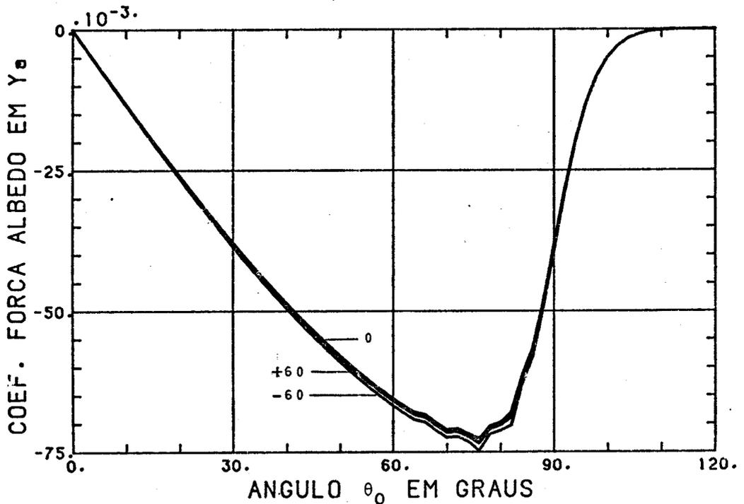
Fig. 7.35 - Componente horizontal do coeficiente do albedo em função de  $\theta_0$  e  $\theta_s$  ( $\gamma = \rho = 0,7$ ;  $\phi_s = 60^\circ$ ;  $\psi_s = 0$  e  $h = 700$  km).
