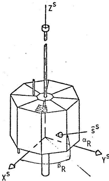
Fig. 7.13 - Ângulos de incidência  $\alpha_R$  e  $\beta_R$  da radiação solar no sistema do satélite.
