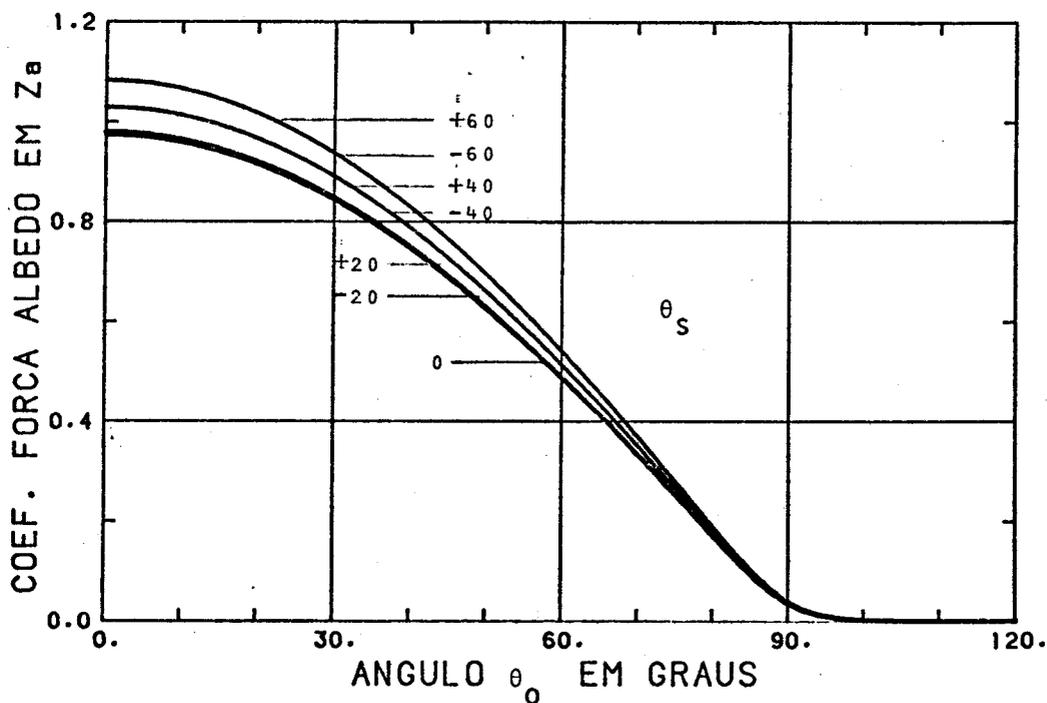
Fig. 7.34 - Componente vertical do coeficiente do albedo em função de  $\theta_0$  e  $\theta_s$  ( $\psi_s = 0$ ,  $\phi_s = 90^0$ ,  $\gamma = \rho = 0,7$  e  $h = 700$  km).
