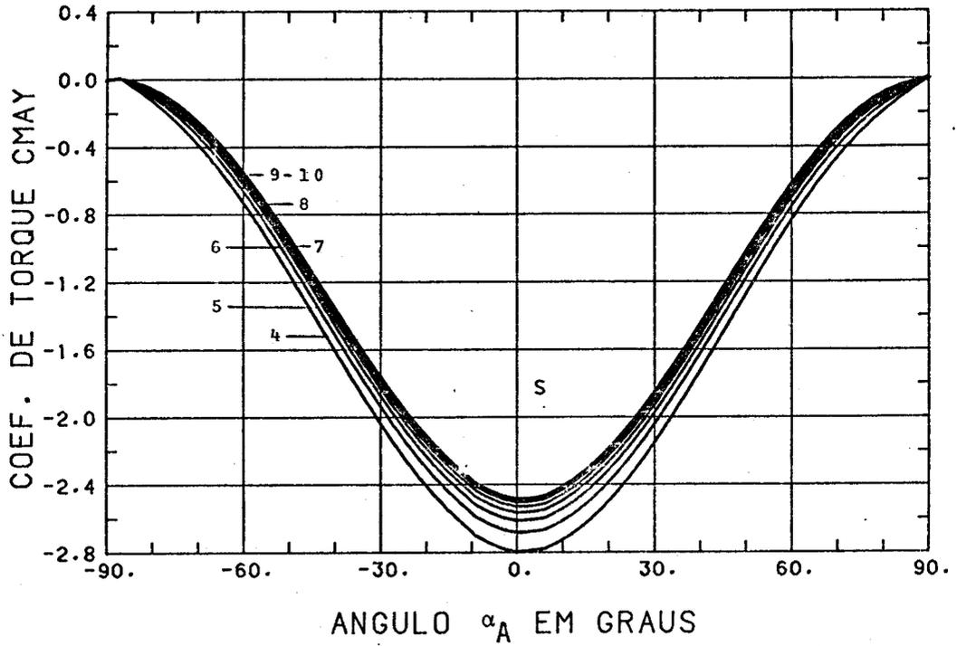
Fig. 7.9 - Coeficiente de torque no eixo  $Y^S$  do satélite, em função do ângulo  $\alpha_A$  e de  $s$ , para  $\beta_A = 0$  e  $\sigma = \sigma' = T_W/T_i = 1$ .
