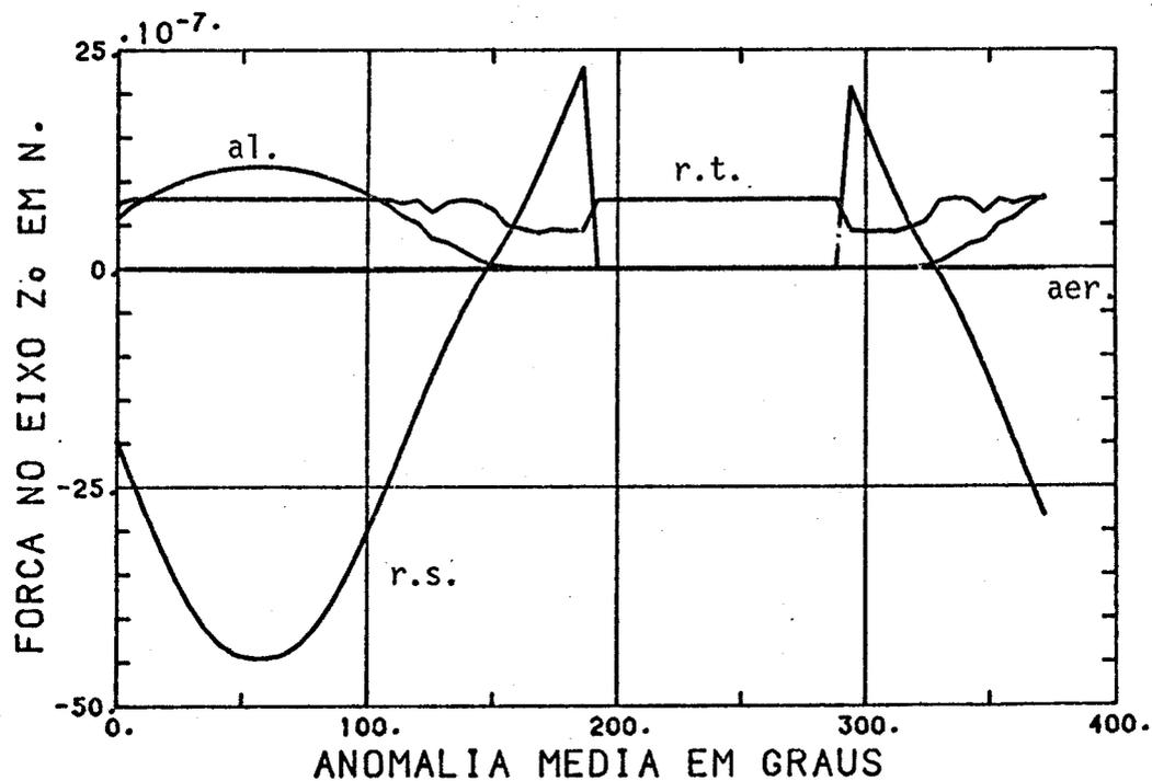
Fig. 7.53 - Forças em N no eixo Z<sup>0</sup> (elementos orbitais: a = 7128 km, e = 0,007, i = 22<sup>o</sup>, Ω = 180<sup>o</sup> e ω = 14,3<sup>o</sup>).
