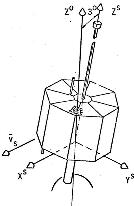
Fig. 7.61 - Ponto de equilíbrio entre os torques aerodinâmicos e de gradiente de gravidade, a 500 km de altitude.
