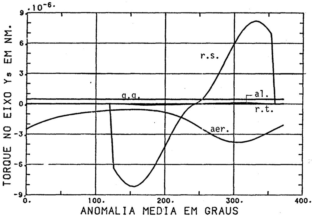
Fig. 7.49 - Torques em Nm no eixo  $Y^S$  do sistema do satélite (orientação com relação ao sistema orbital:  $\phi_s = \theta_s = \psi_s = 0$ ).
