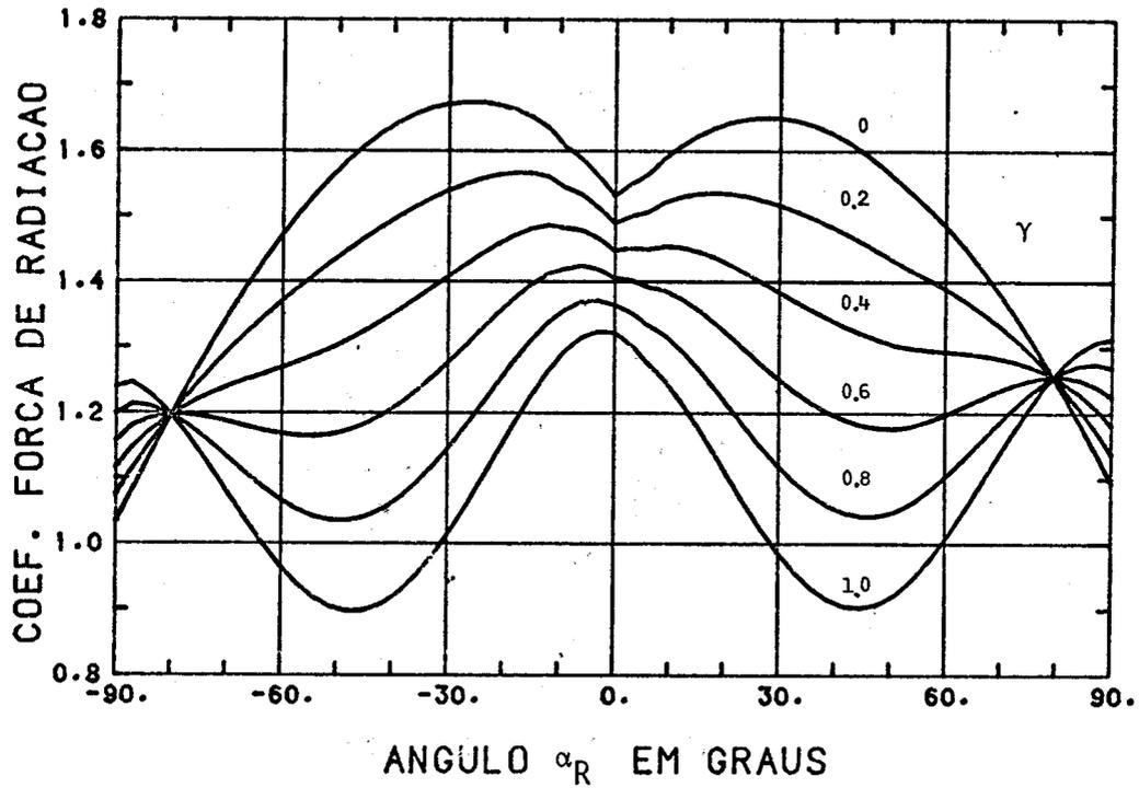
Fig. 7.20 - Influência de  $\gamma$  no coeficiente de força de radiação em função do ângulo  $\alpha_R$  ( $\beta_R = 22,5^\circ$  e  $\rho = 1,0$ ).
