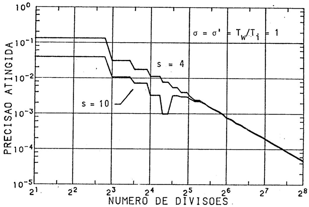
Fig. A.3 - Precisão da integração do coeficiente de arrasto numa esfera, em função do número de divisões.
