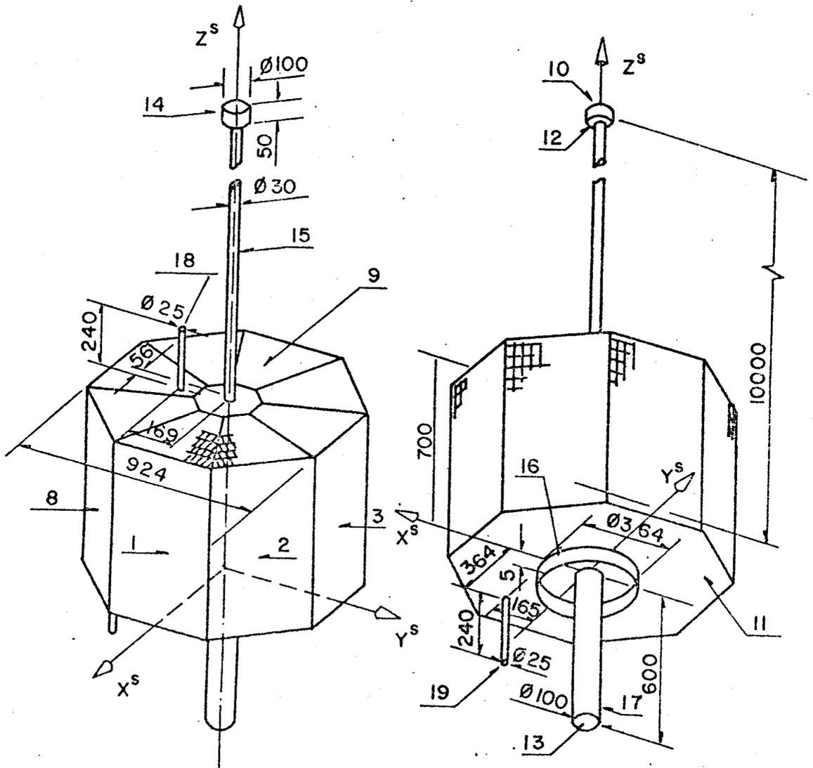
Fig. 7.1 - Geometria, dimensões e eixos do satélite experimental.
