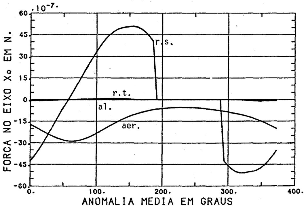
Fig. 7.51 - Forças em N no eixo  $X^0$  (elementos orbitais:  $a = 7128$  km,  $e = 0,007$ ,  $i = 22^\circ$ ,  $\Omega = 180^\circ$  e  $\omega = 14,3^\circ$ ).
