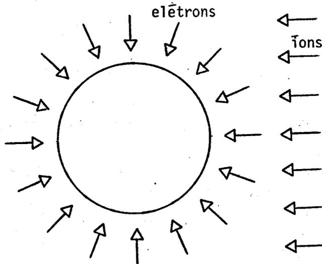
Fig. 6.1 - Velocidades dos elétrons e íons com relação ao satélite, na ausência de campo magnético.
