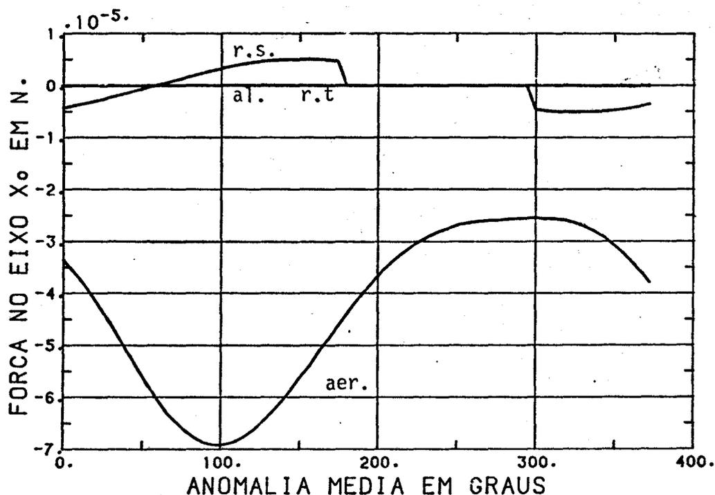
Fig. 7.57 - Forças no eixo  $X^0$  em N (elementos orbitais:  $a = 6878 \text{ km}$ ,  $e = 0$ ,  $i = 22^\circ$ ,  $\omega = 14,3^\circ$ ,  $\Omega = 180^\circ$  e  $h = 500 \text{ km}$ ).
