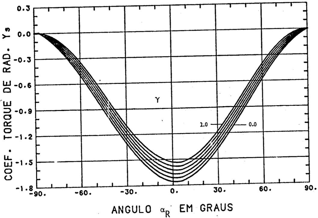
Fig. 7.27 - Coeficiente do torque de radiação no eixo Y<sup>S</sup> em função do ângulo  $\alpha_R$  e de  $\gamma$  ( $\beta_R = 0^\circ$  e  $\rho = 1,0$ ).
