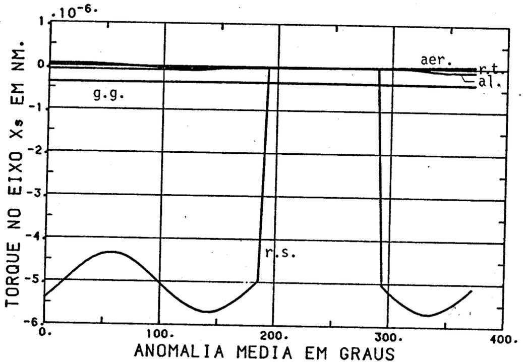
Fig. 7.54 - Torques em Nm no eixo  $X^S$  (ângulos de atitude com relação ao sistema orbital:  $\phi_s = \theta_s = \psi_s = 0^\circ$ ).
