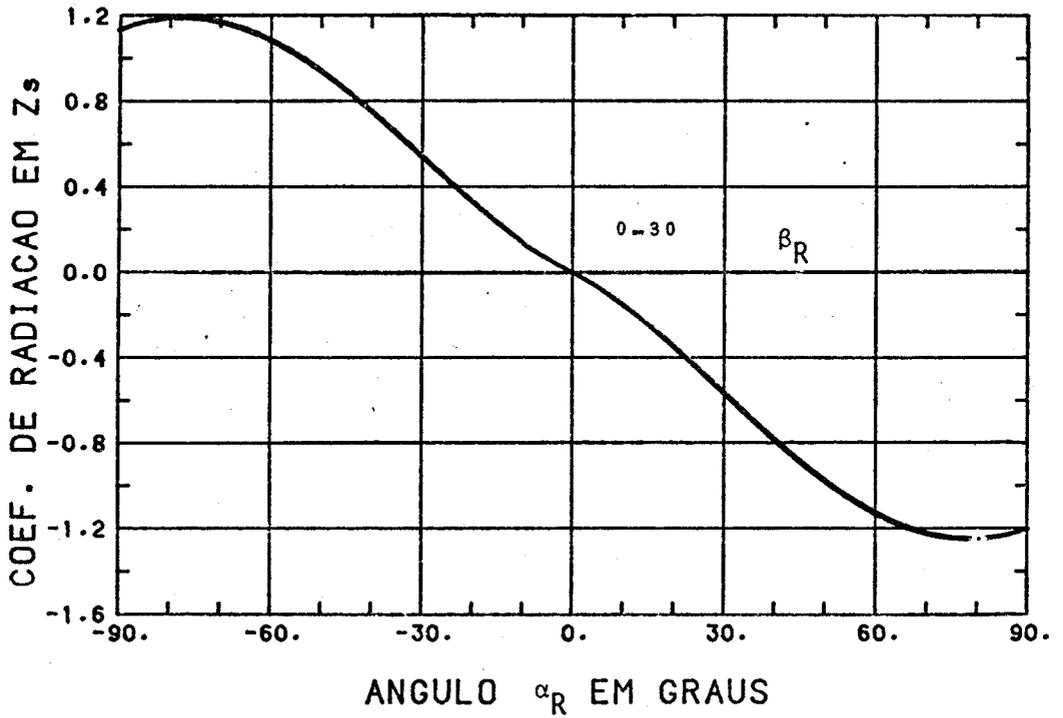
Fig. 7.18 - Coeficiente de força de radiação no eixo  $Z^S$  em função dos ângulos  $\alpha_R$  e  $\beta_R$  (reflectância e parcela especular:  $\gamma = \rho = 0,7$ ).
