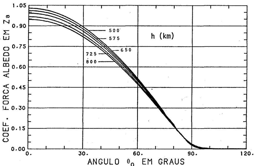
Fig. 7.30 - Componente do coeficiente de força do albedo na direção de  $Z^S$  em função de  $\theta_0$  e da altitude h ( $\gamma = \rho = 0,7$ ).
