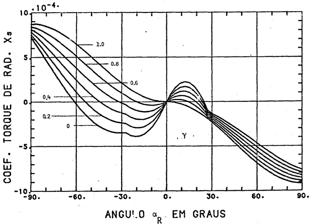
Fig. 7.26 - Coeficiente do torque de radiação no eixo  $X^s$  ( $\beta_R = 0^0$ ,  $\rho = 1,0$ ).
