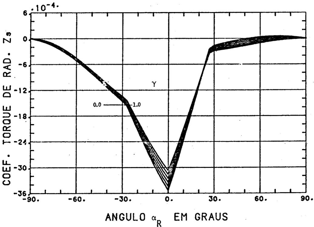
Fig. 7.28 - Coeficiente do torque de radiação no eixo Z<sup>S</sup> em função de  $\alpha_R$  e  $\gamma$  ( $\beta_R = 0^\circ$  e  $\rho = 1,0$ ).
