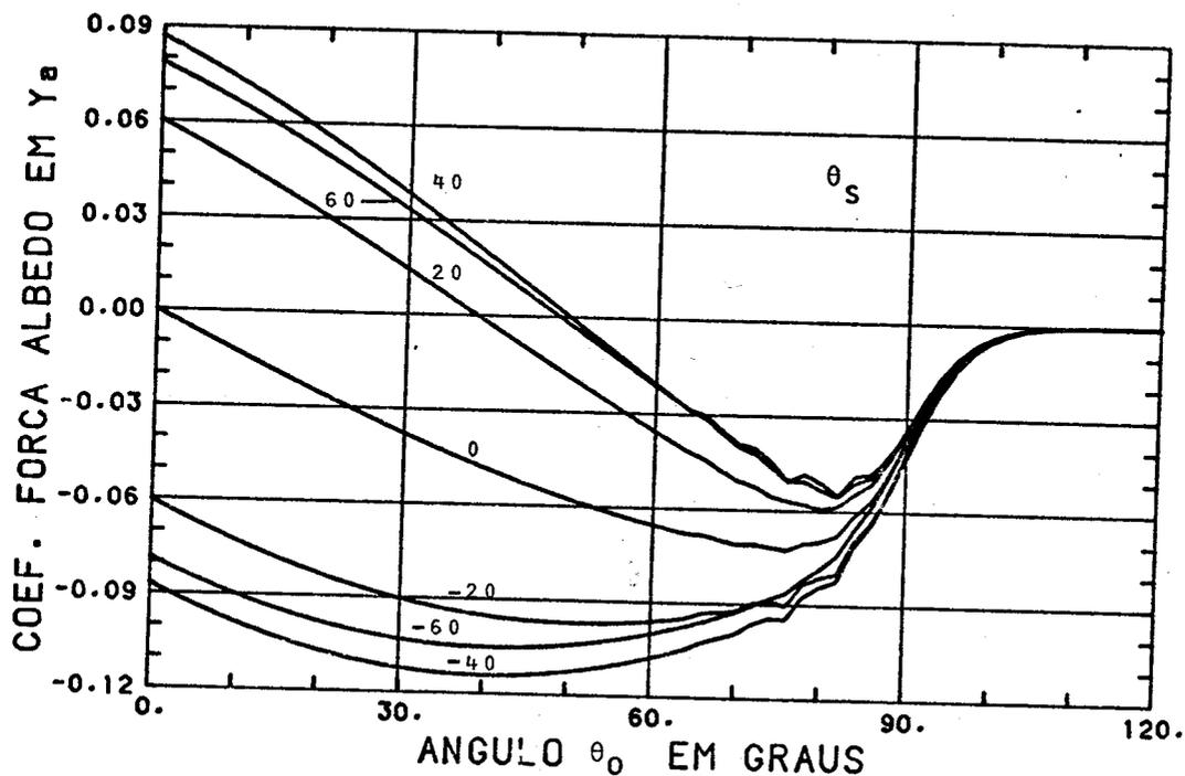
Fig. 7.33 - Componente horizontal do coeficiente do albedo em função de  $\theta_0$  e  $\theta_s$  ( $\phi_s = \psi_s = 0$ ;  $\gamma = \rho = 0,7$  e  $h = 700$  km).
