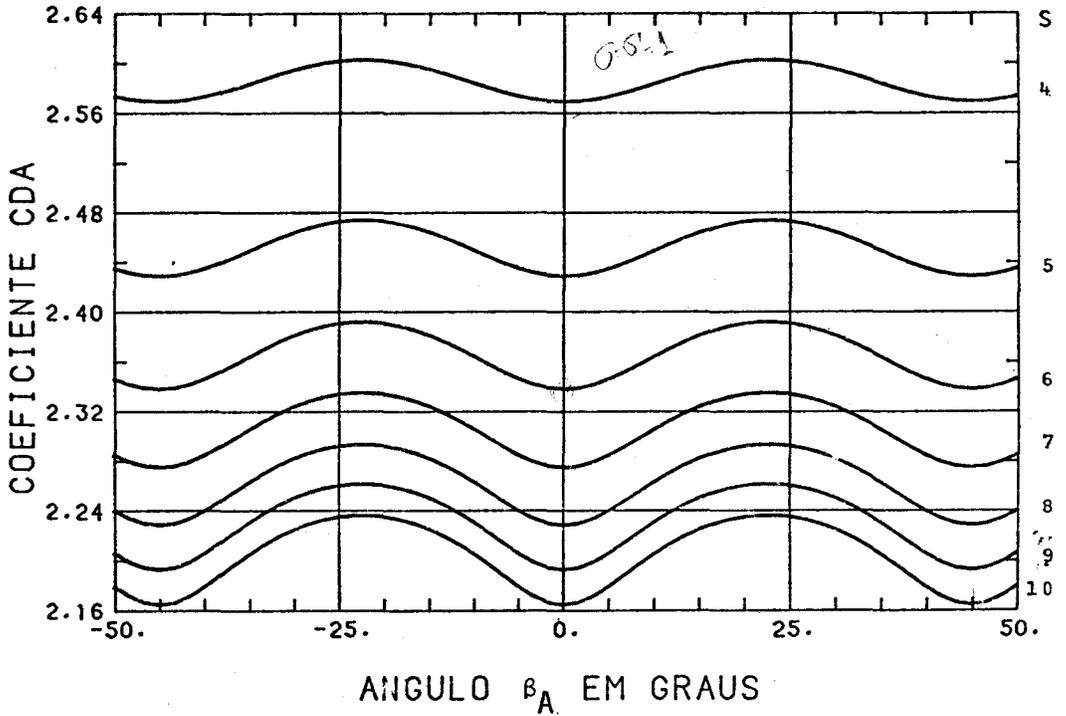
Fig. 7.3 - Coeficiente de arrasto aerodinâmico, como função do ângulo  $\beta_A$ , para alguns valores da razão de velocidades  $s$ .
