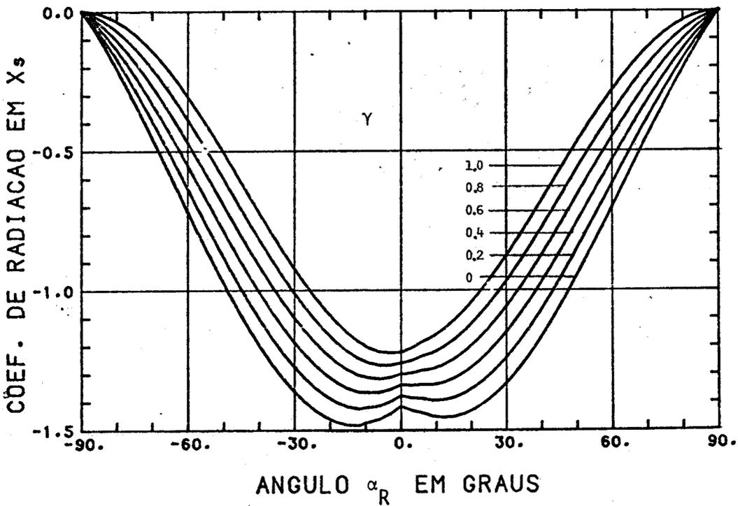
Fig. 7.21 - Componente do coeficiente de radiação no eixo  $X^S$  em função de  $\alpha_R$  e  $\gamma$  ( $\beta_R = 22,5^\circ$  e  $\rho = 1,0$ ).
