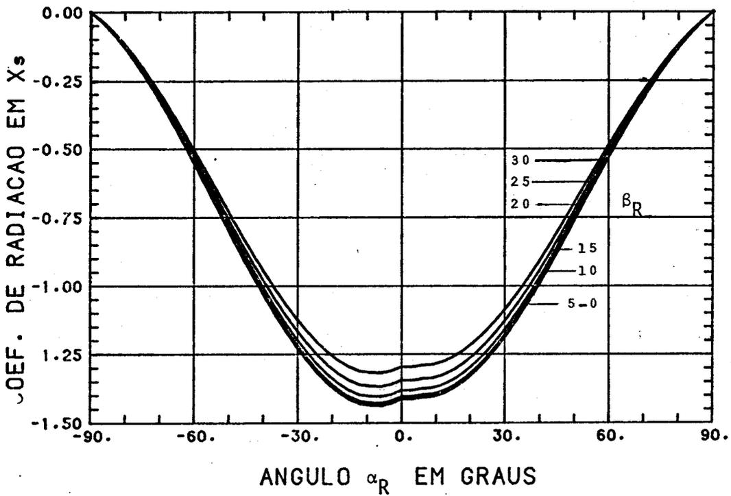
Fig. 7.16 - Componente do coeficiente de força de radiação no eixo Xs, em função de alpha\_R e beta\_R, para gamma = rho = 0,7.
