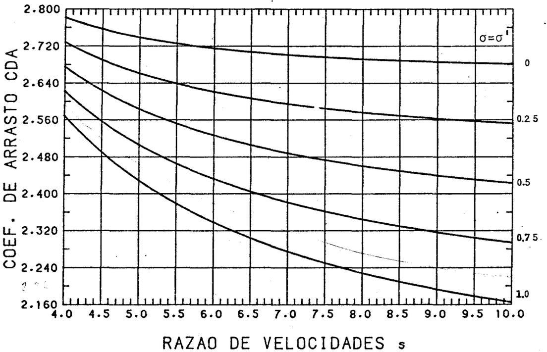
Fig. 7.4 - Coeficiente de arrasto,  $C_{DA}$ , em função da razão de velocidades  $s$  e de  $\sigma$  e  $\sigma'$  (ângulos de ataque nulos:  $\alpha_A = \beta_A = 0$ ).
