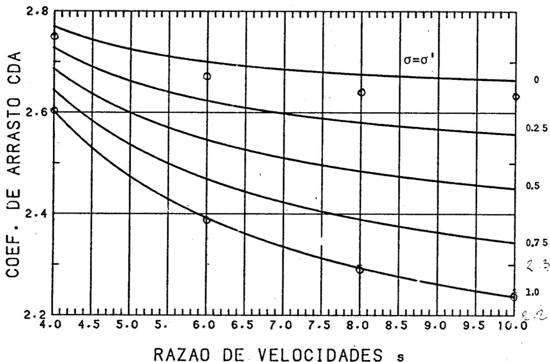
Fig. 7.5 - Coeficiente de arrasto, em função de  $s$  com  $\sigma$  e  $\sigma'$  variando de 0 a 1 (ângulos de ataque:  $\alpha_A = 0$ ,  $\beta_A = 22,5^\circ$  e  $T_w/T_i = 1$ ).
