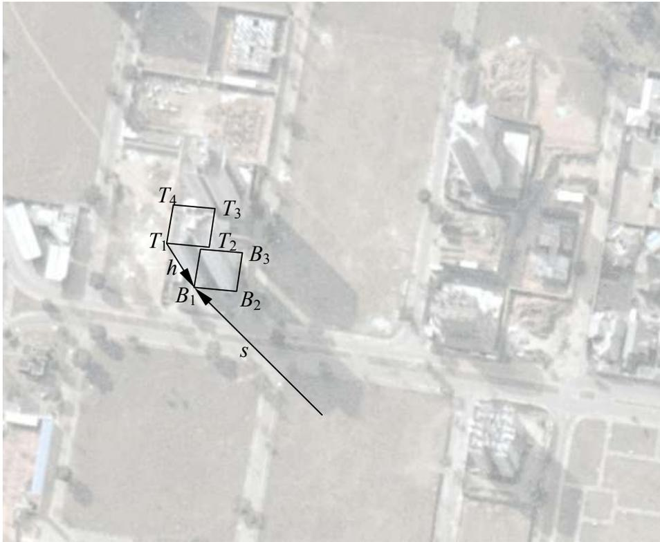
Figura 4. Imagem aérea e os principais pontos que devem ser utilizados no processo de reconstrução. O contraste da imagem foi reduzido artificialmente
